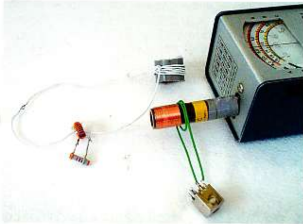
Het bewikkelde ringkernetje heeft met een C van 27 pF een resonantiefrequentie van 6 MHz. De MF-trafo voor 10,7 MHz blijkt met de kern over bijna 3 MHz verstemd te kunnen worden.
